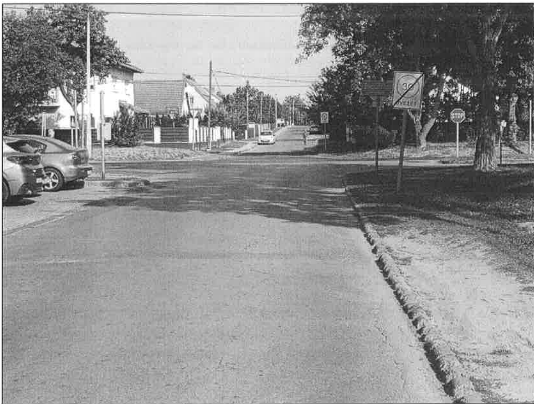
15. sz. fénykép: A Széchenyi utca Pécsi úti csatlakozásában nem megfelelően észlelhető „STOP” tábla
