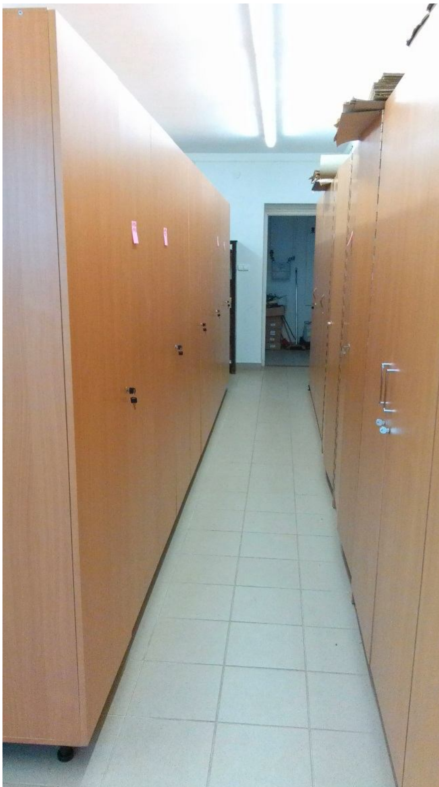
8. kép – A levéltári raktárhelyiség. A csempepadló és a könnyen tisztítható felületek minimalizálják a porszennyezést. A fából készült bútorok azonban egyéb veszélyeket is rejthetnek magukban (ragasztóanyag, lakk párolgása, stb.). A megvilágítást plexiborítású neoncsövek szolgáltatják.
